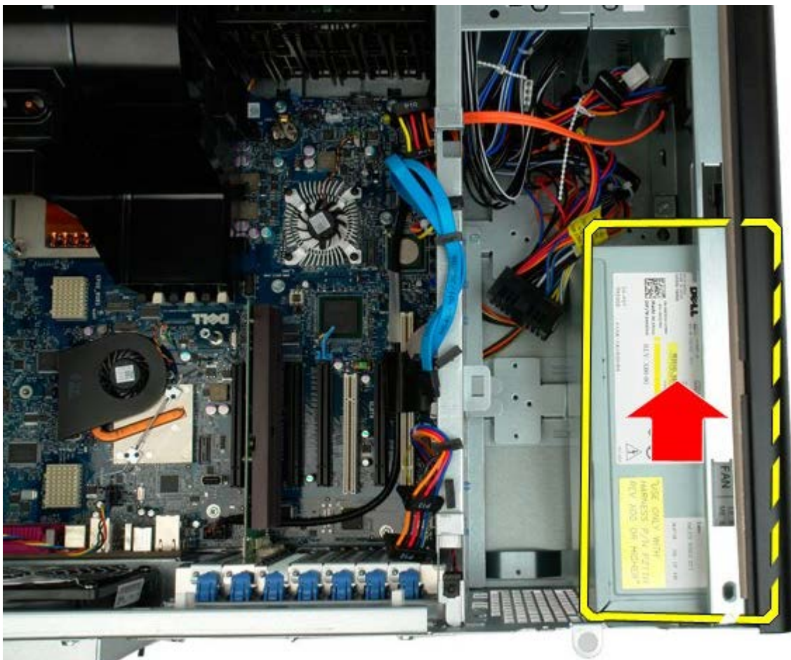
7. コンピュータから斜めに PSU を取り外します。
